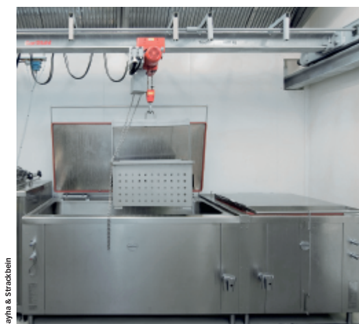
Die Kochkesselanlage 2000 Plus hat einen fugenlos verschweißten Kesseleinsatz.
